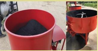
б) Конструкции со съемными емкостями и верхним расположением двигателя
