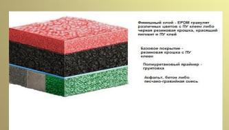
Важно! Не использовать спиртосодержащие и нитрорастворители. Воздействие атмосферных осадков в течение суток после укладки покрытия не допускается. Эксплуатация покрытия в полном объеме разрешается через неделю после укладки.
